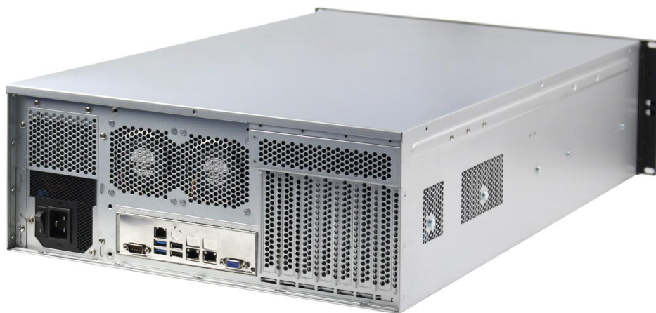
5 卡 GPU 服务器机箱后视图
